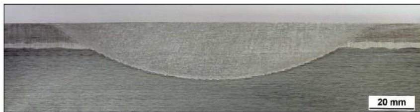
Obr. 4: Makrostruktura opravného návaru kavity materiálem Inconel FM 52/52M
