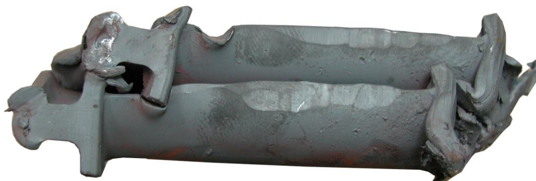
Obr. 3: Důsledek ventilace VT lopatkování při chodu naprázdno
