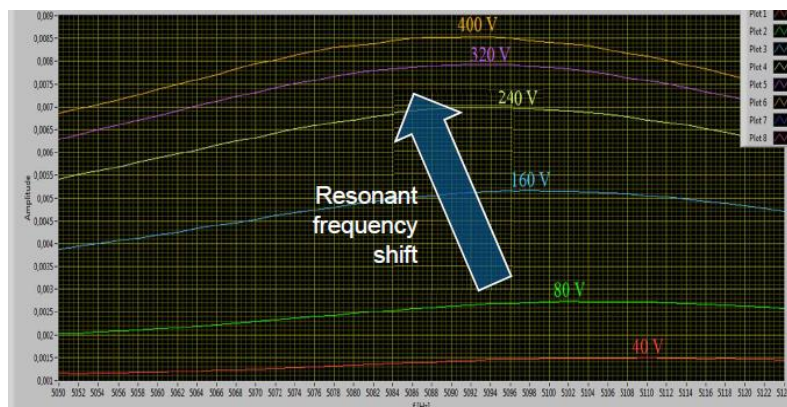
Obr. 4: Obrázek demonstrující principy NRUS techniky (úroveň budícího signálu 40–400 V)
