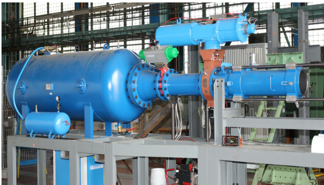
Obr. 1: Pneumatická děla VZLÚ s průměrem hlavní 125 mm (nahore) a 260 mm (dole)
