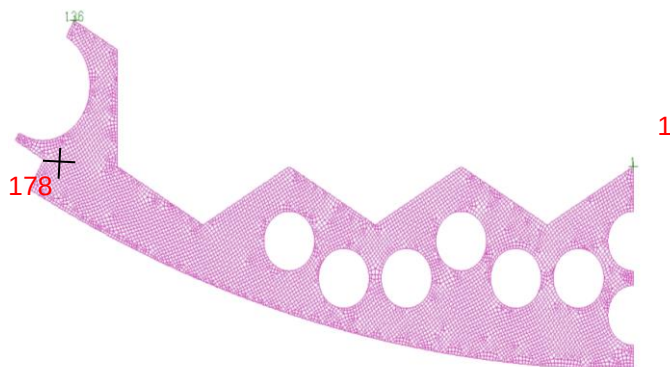
Obr. 8: Vybrané konstrukční uzly PAZ pro hodnocení deformačního creepu a bobtnání projevujících se makroskopickou deformací PAZ [3]
