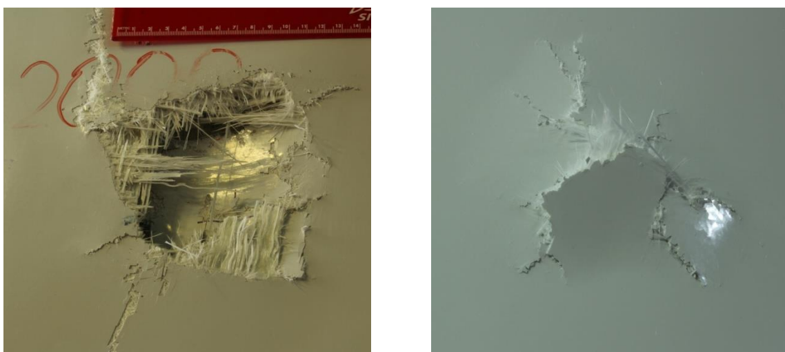
Obr. 6: Poškození přední (vlevo) a zadní stěny (vpravo) – druhý impakt
