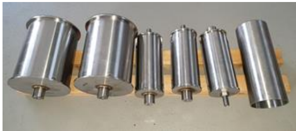
Obr. 6: Polotovary s přípravkem připravené pro zhotovení povlaku technologií CS
