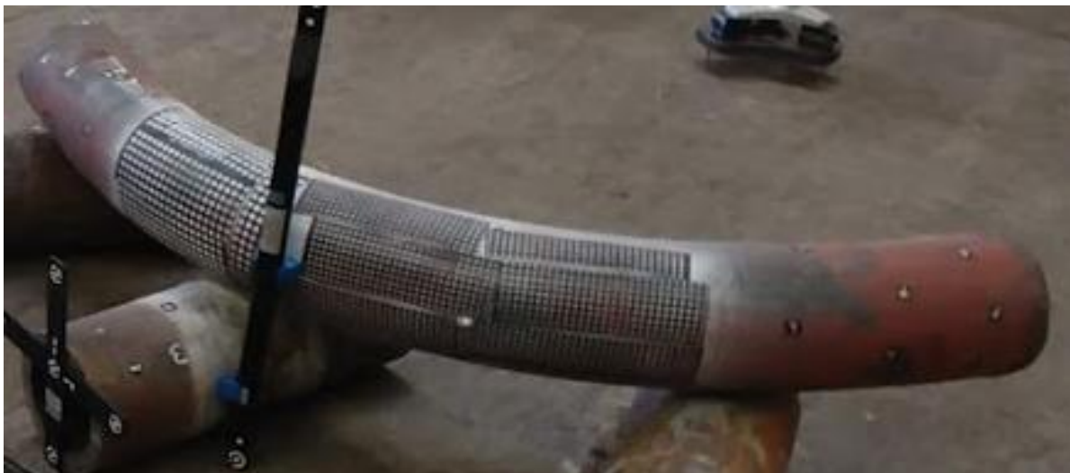
Obr. 5: Fotogrammetrické měření TTR B5, ohyb č. 6
