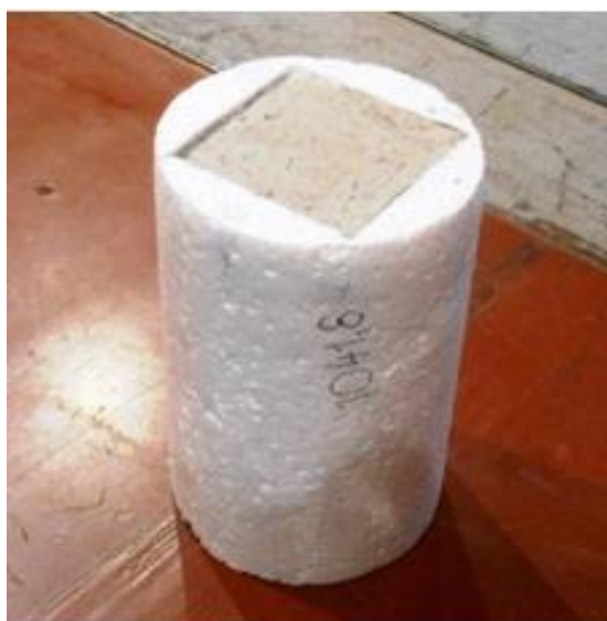
Obr. 3: Projektil: betonové těleso před a po experimentu (první impakt)
