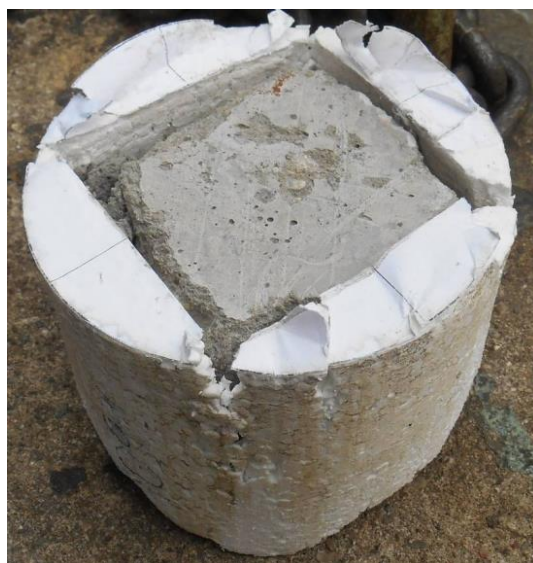
Obr. 3: Projektil: betonové těleso před a po experimentu (první impakt)
