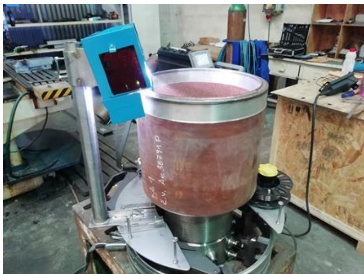
Obr. 6: Navařování návaru a provedení svarového spoje automatem
