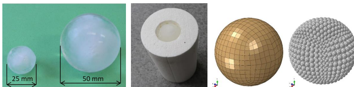
Obr. 7: Kroupa, její umístění v pouzdru, model MKP, model SHP elementy
