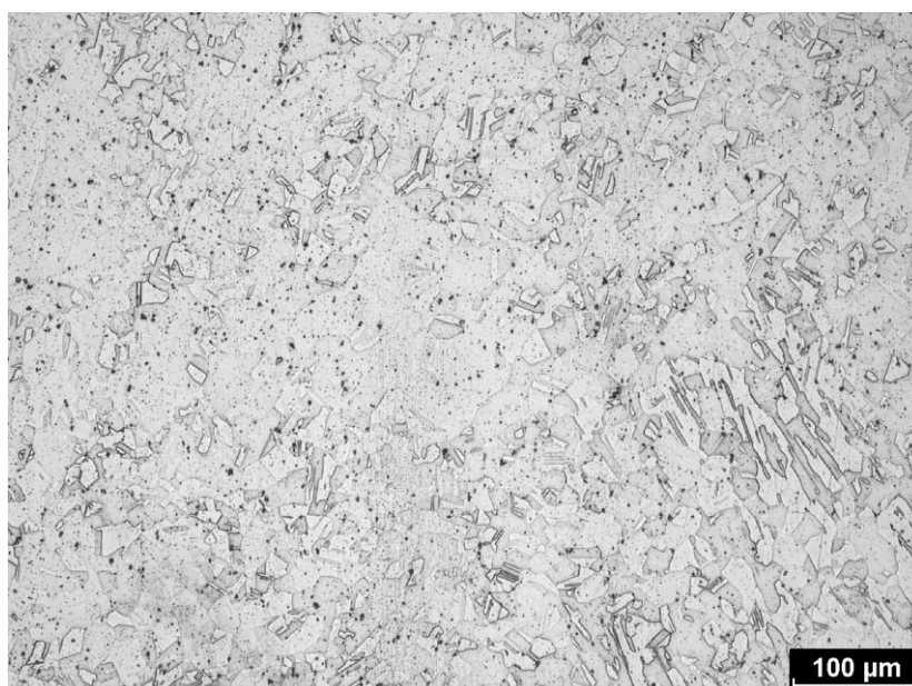
Obr. 1: Mikrostruktura dodané oceli SUPER 304H (světelný mikroskop)
