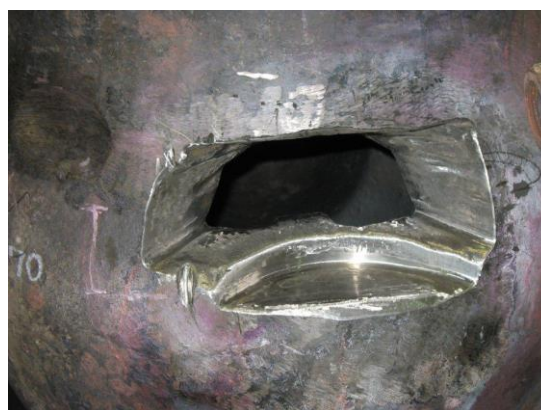
Obr. 4: Odstranění defektu skrze celou stěnu ventilu
