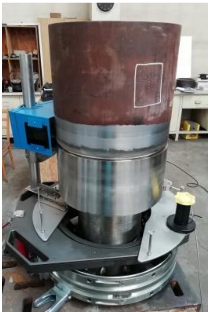
Obr. 5: Navařování návaru a provedení svarového spoje automatem
