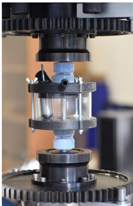
Obr. 1: Měřicí cela pro zkoušky korozní vysokocyklové únavy
