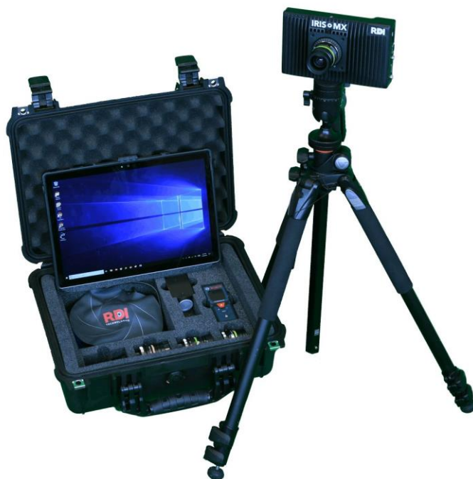
Obr. 1: Systém pro měření vibrací kamerou IRIS MX (bez osvětlovací techniky)
