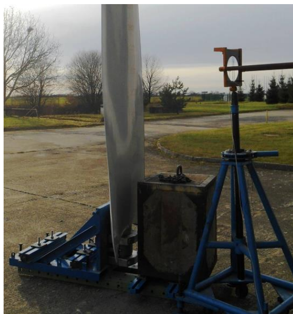
Obr. 2: Realizace zkoušky impakt betonovým tělesem
