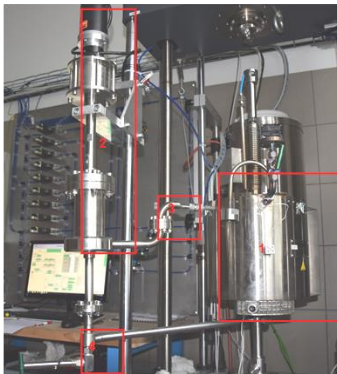
Obr. 2: Zkušební HLM komora s cirkulační smyčkou pro tekutý kov. 1 – zkušební komora, 2 – čerpadlo, 3 – pouzdro pro Mg-pásku, 4 – HLM výpust’.
