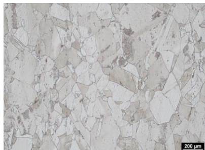
Obr. 3: Mikrostruktura austenitické nerezavějící oceli 08Ch18N10T v neozářeném stavu při různých zvětšeních (nežíháno, neleptáno)
