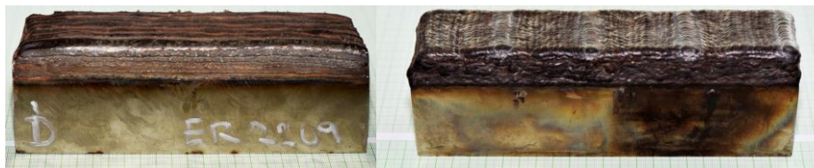
Obr. 2: Návary duplexní oceli ER 2209 a A/M oceli Avesta 248 SV na oceli COR 13/4
