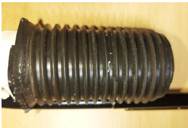
Obr. 2: Replika závitového hnízda (100 % povrchu vnitřního závitu)
