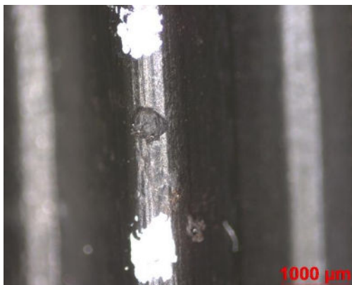
Obr. 4: Detail korozního důlku
