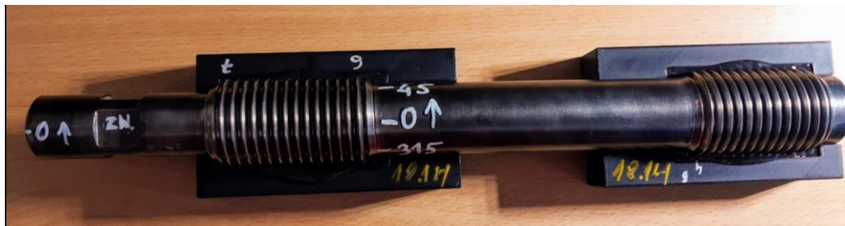
Obr. 1: Svorník HRK umístěn ve formičkách pro odlévání repliky
