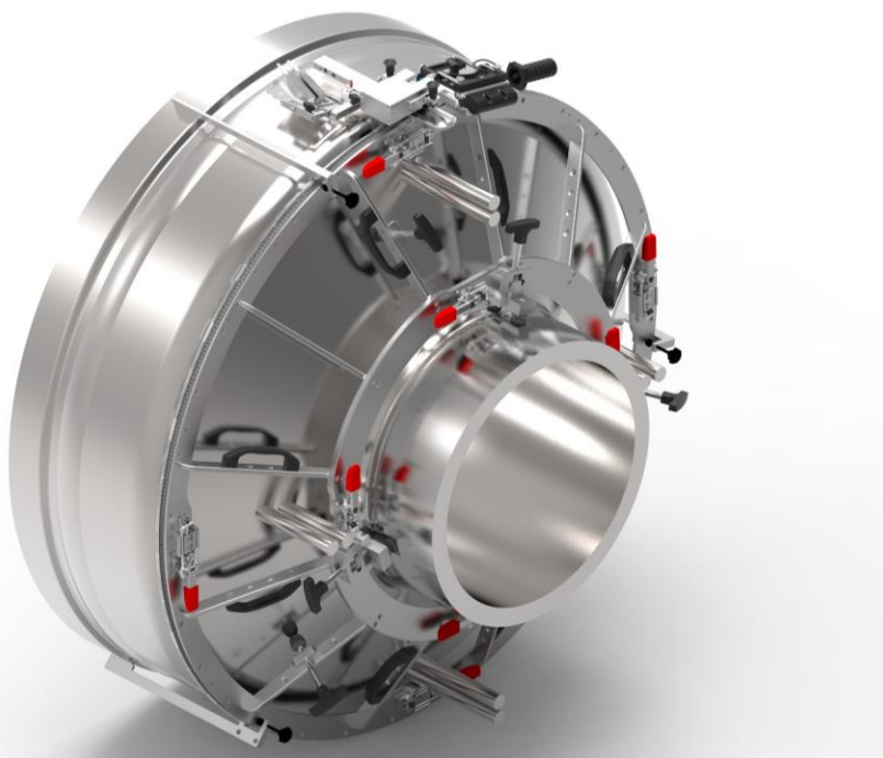
Obr. 3: Sestava manipulátoru Fillass na hrdle kolektoru PG
