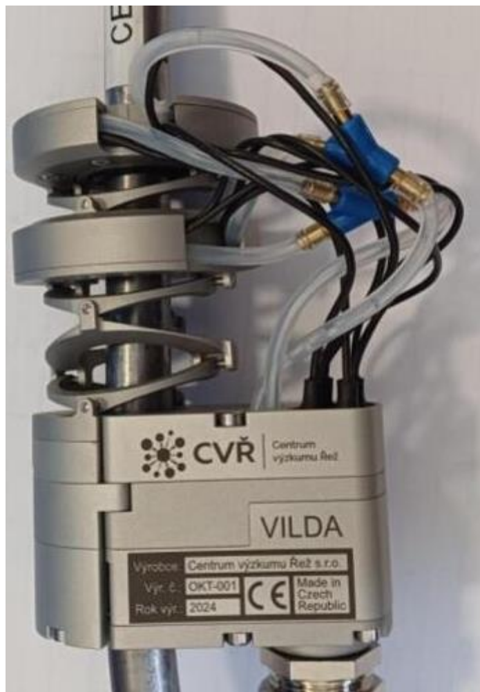
Obr. 1: Manipulátor OKT nasazený na zkušební trubce
