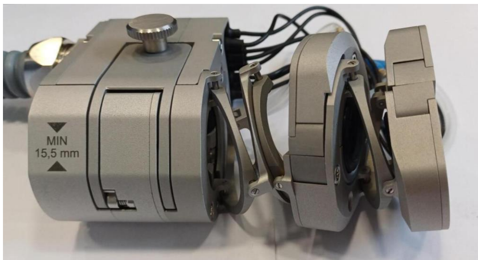
Obr. 2: Manipulátor z pohledu své nejmenší světlé průjezdné výšky
