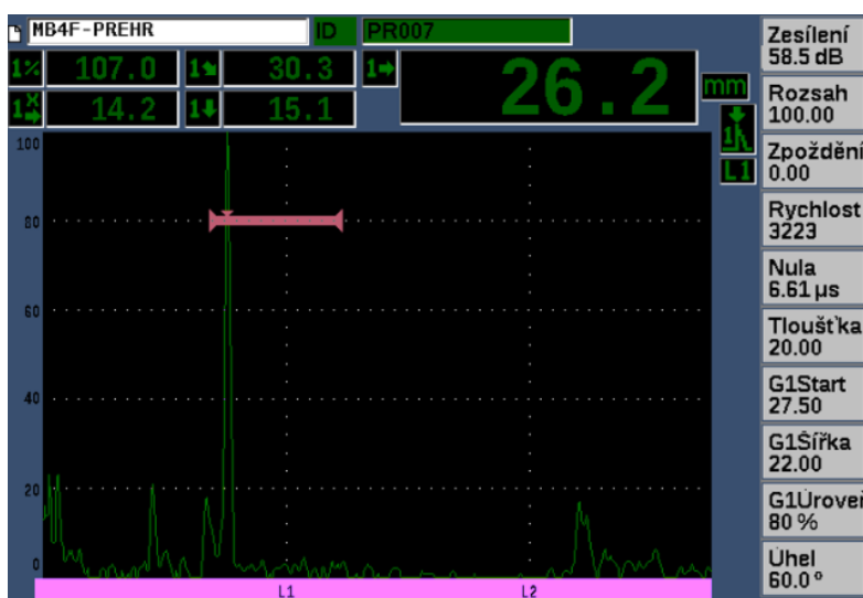
Obr. 2: Příklad indikace v oblasti kořene svarového spoje
