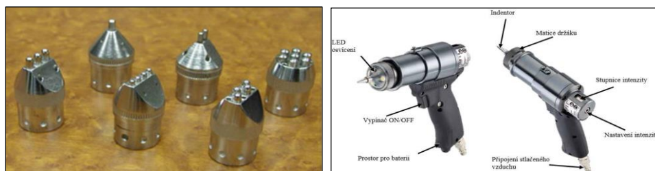
Obr. 1: Pneumatická pistole HiFIT a používané indentory [https://www.hifit.de/en/products]
