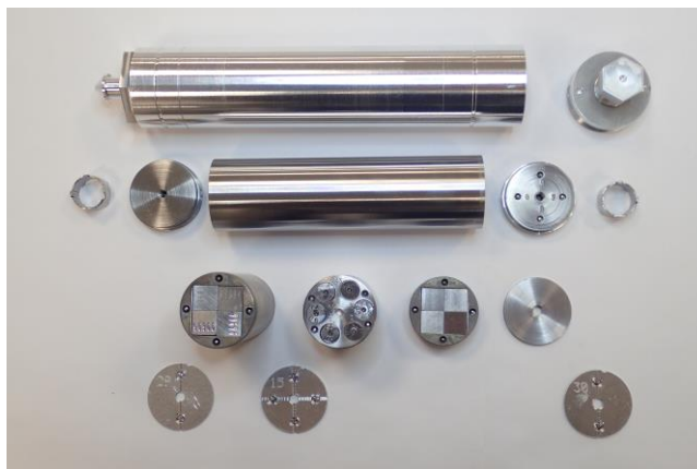
Obr. 4: Komponenty schránky pro nízkoteplotní ozařování před kompletací
