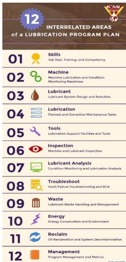
Obr. 1: Soubor oblastí patřících k managementu mazání dle normy ICML 55.1
