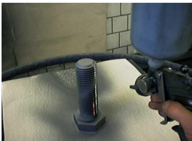
Obr. 8: Potažení závitu kluzným lakem
