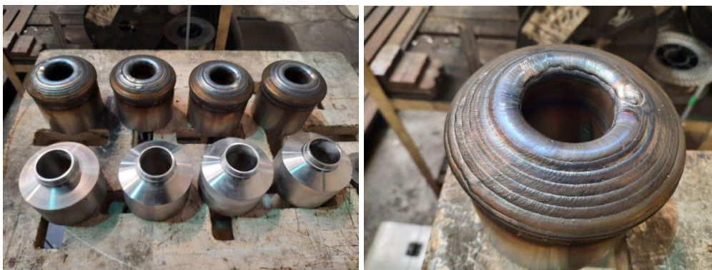
Obr. 5: Výroba navařováním předběžného dvouvrstvého návaru na ocel 22K
