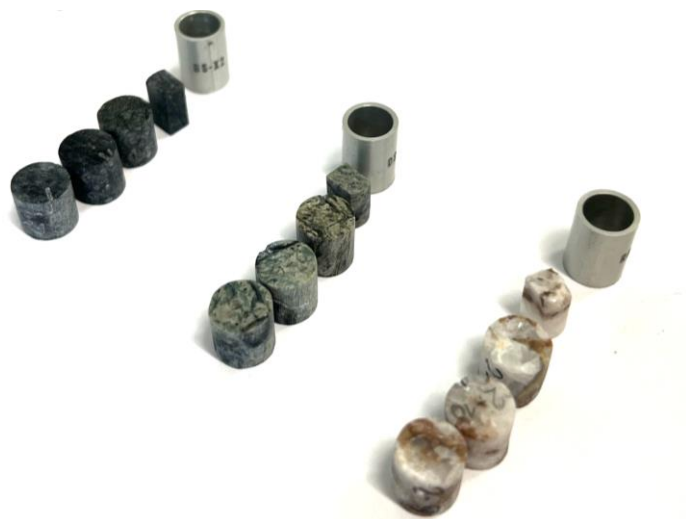
Obr. 1: Vzorky tří typů kameniva vybrané k umístění do ozařovací sondy spolu s kovovým pouzdrem (vpravo) pro umístění řezu určeného k práškové rentgenové difrakci
