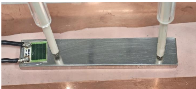
Obr. 6: Reálné provedení měření TEP
