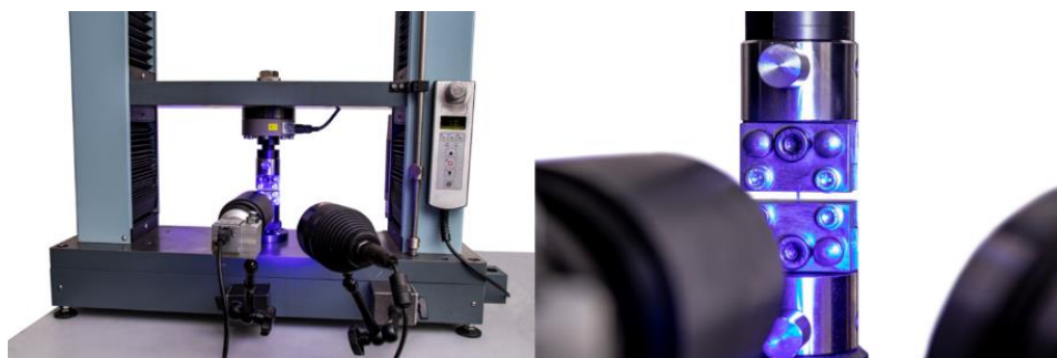
Obr. 3: Zkušební sestava pro zkoušku tahem (vlevo) a detail zkušebního tělesa (vpravo)
