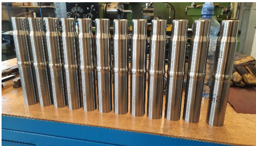
Obr. 7: Příklad hotových heterogenních svařenců malých rozměrů Ø 38×6 mm
