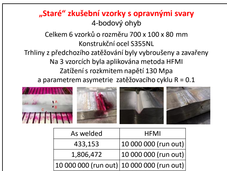
Obr. 7: Fotografie procesu opravy svaru a výsledky únavových zkoušek
