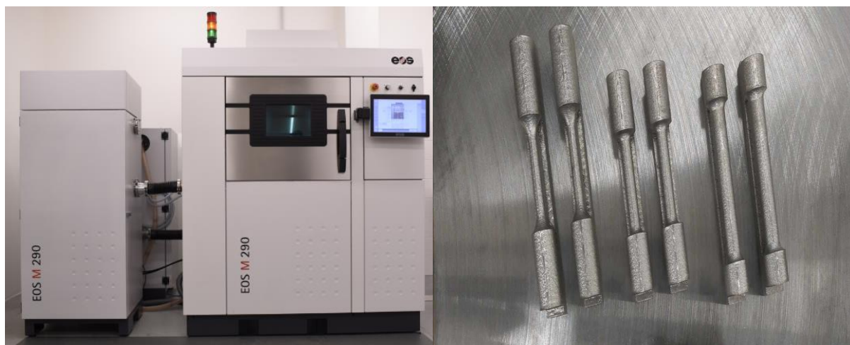
Obr. 1: Tiskárna EOS M290 (vlevo), vytištěné vzorky (vpravo)
