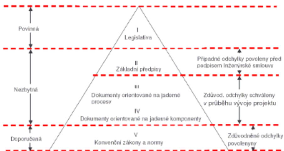
Obr. 1: Struktura projektování JE (převzato z ÚP pro dostavbu EMO34, ŠKODA Praha)
