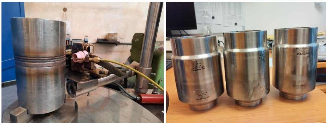
Obr. 6: Pohled na svaření dílů z oceli 22K opatřené návary a oceli 08Ch18N10T na orbitálním svařovacím zařízení a pohled na finální obrobek
