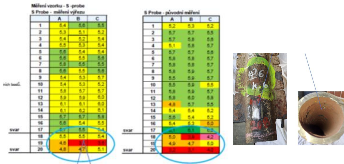
Obr. 11: Porovnání hodnot měřených v kotli a hodnot měřených na výřezu trubky, trubka č. 26, K6, EME
