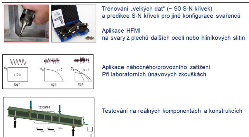
Obr. 10: Návrh dalšího experimentálního ověřování potenciálu uplatnění metody HFMI
