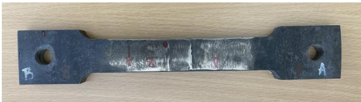
Obr. 1: Zkušební těleso po creepovém zatěžování 2000 h
