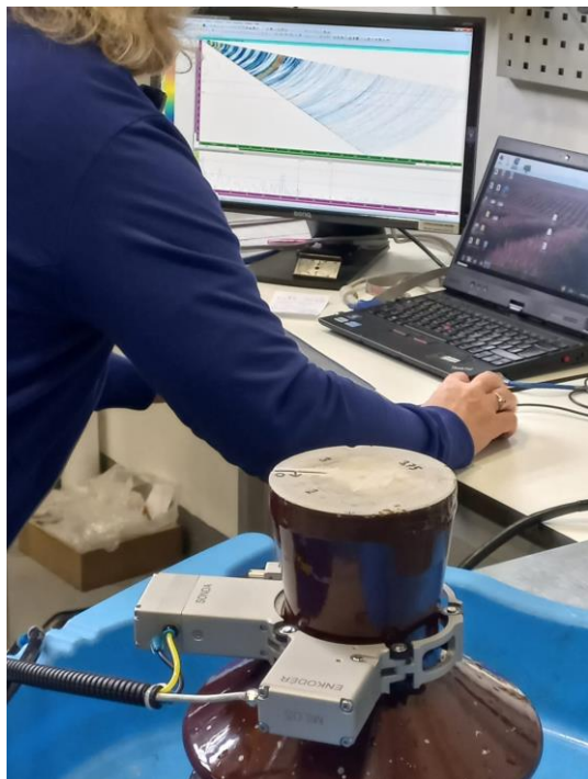
Obr. 6: Manipulátor pro kontrolu izolátorů – Miloš
