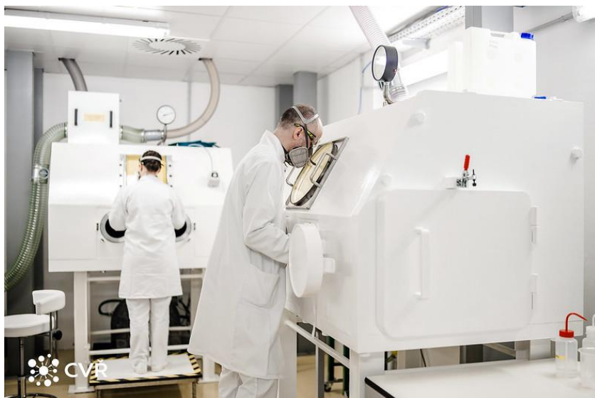
Obr. 2: Rukavicový box infrastruktury CICRR určený pro práci s ozářenými vzorky. Slouží jako přípravná pro vzorky určené k analýzám na SEM-EDS a XRD
