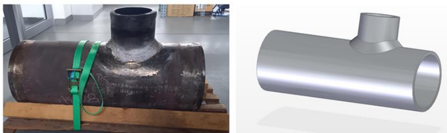
Obr. 3: Zkušební těleso – T kus KR 375/220
